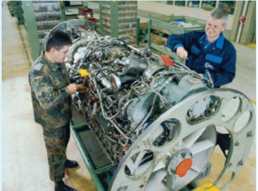
Reparatur eines J79-Triebwerks für die Phantom.
